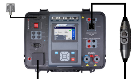
Die Messungen der Auslösezeit und des Auslösestroms.
